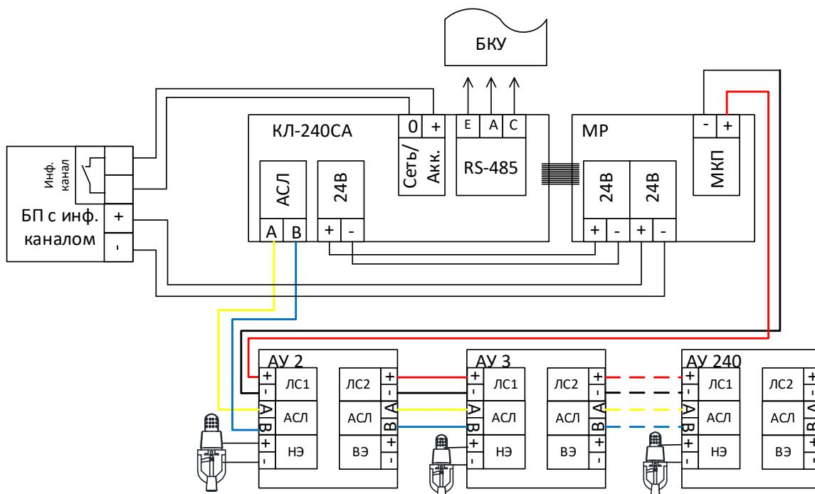
Рисунок 58 – Схема подключения ИПП-СкА / СА.
