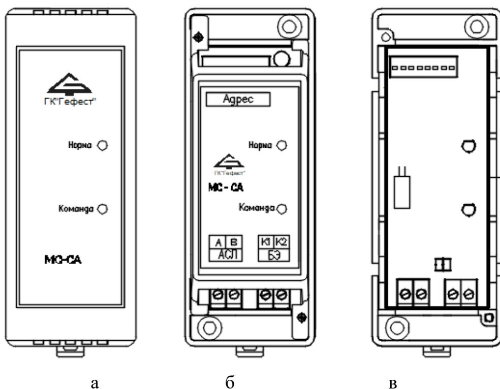
Рисунок 63 – Внешний вид MC-СА (а); вид со снятой верхней крышкой (б); вид со снятой внутренней крышкой (в).
