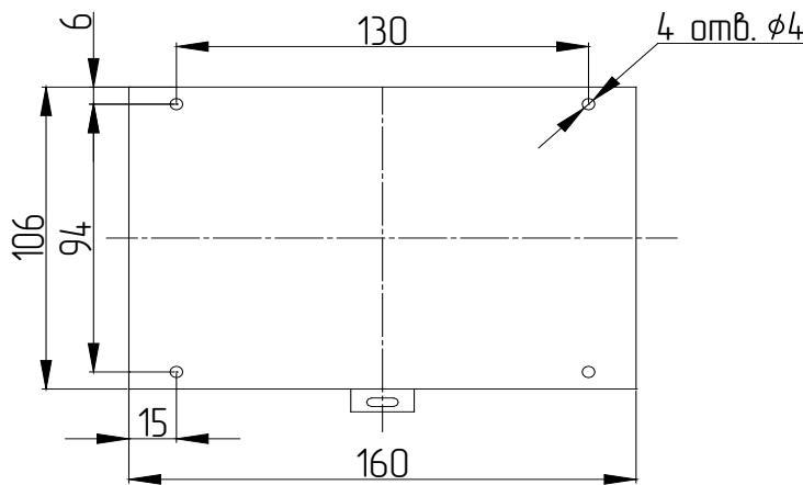
Рисунок 52 – Установочные размеры КЛ-240АЭ.
