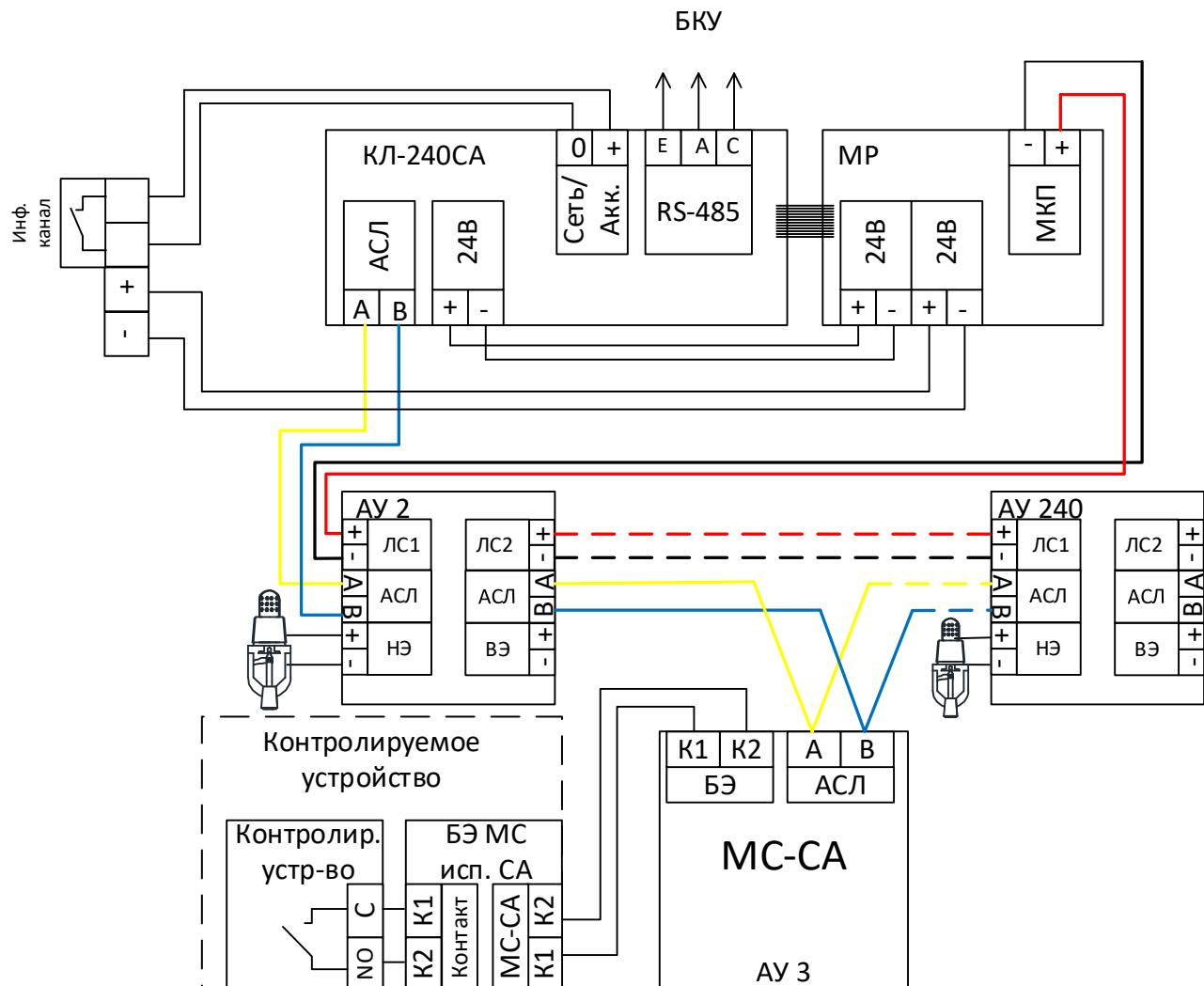
Рисунок 65 – Схема подключений MC-СА.
