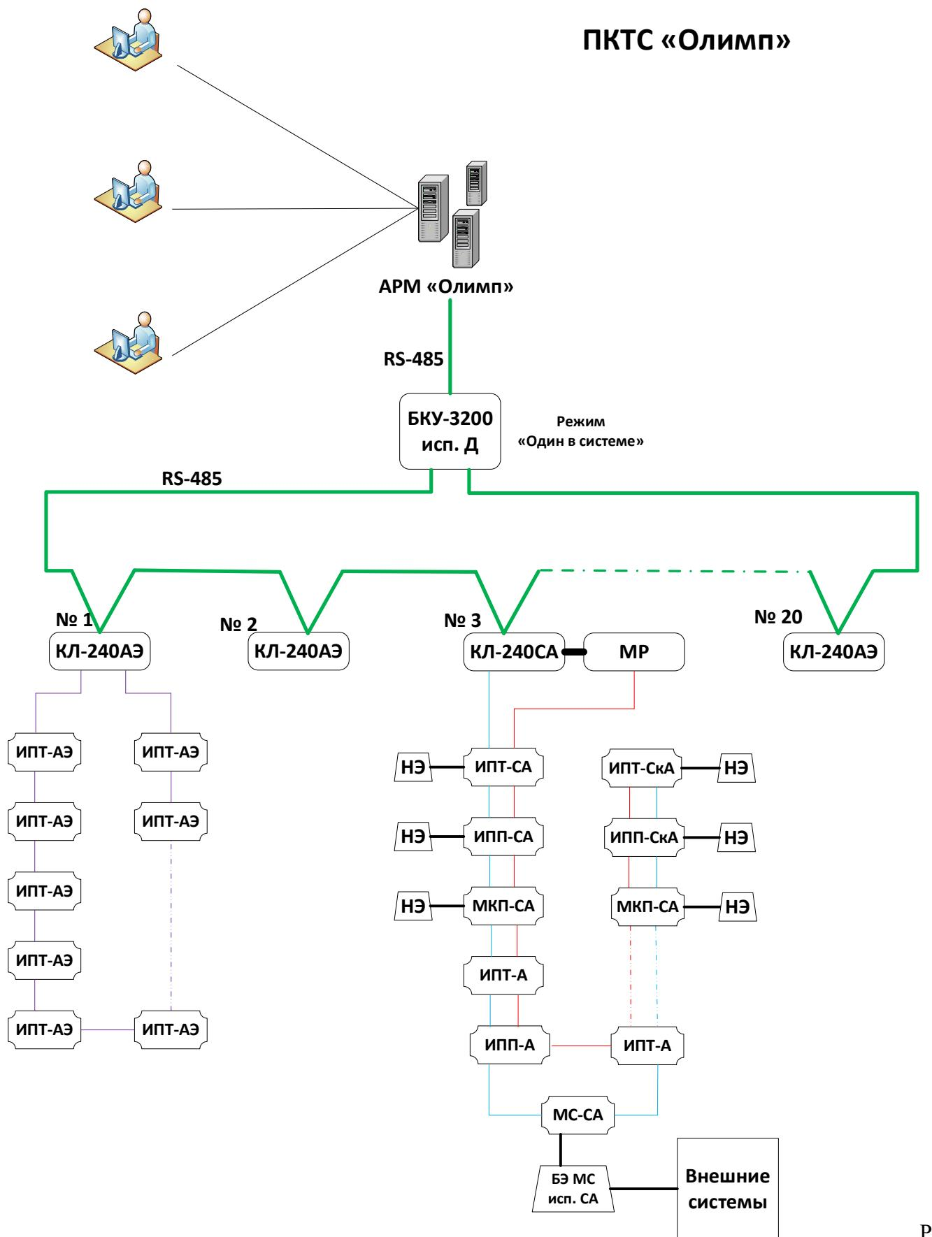
исунок 1 – Структура системы с максимальным количеством адресов 4 800.
