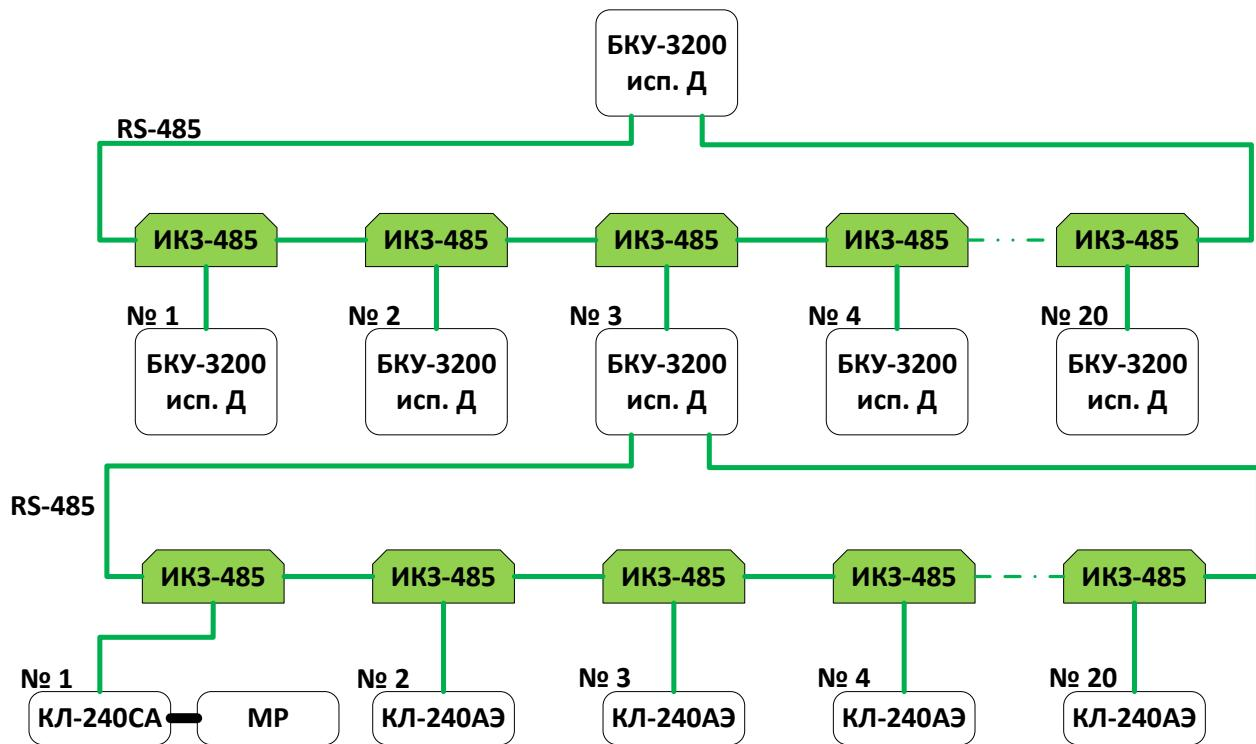
Рисунок 70 – Пример с использованием ИКЗ-485
