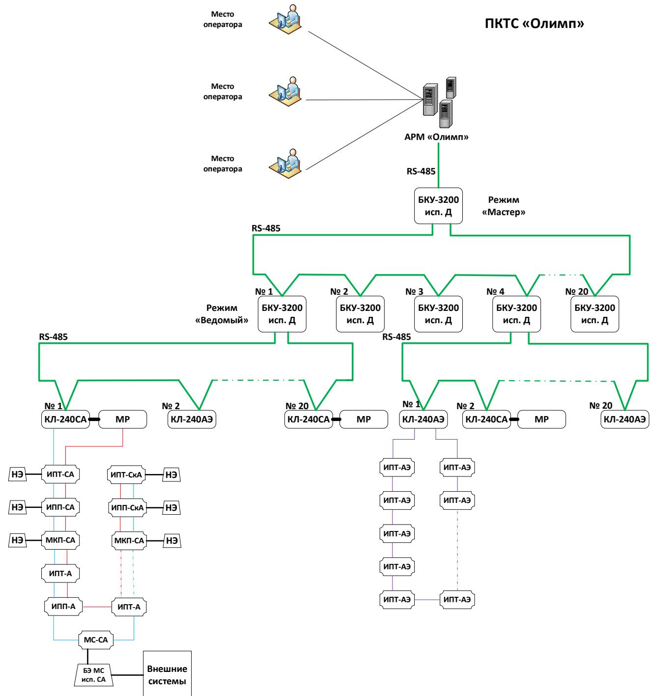
Рисунок 2 – Структура системы с максимальным количеством адресов 96 000.
