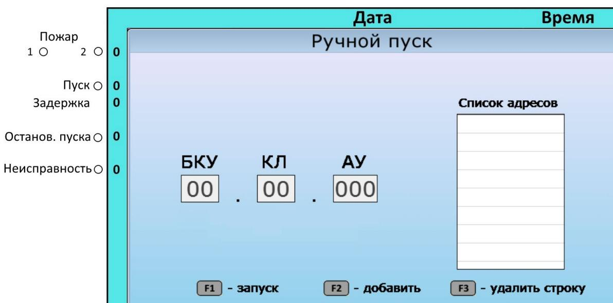
Рисунок 20 – Пример экрана выбора адресов для ручного пуска.
