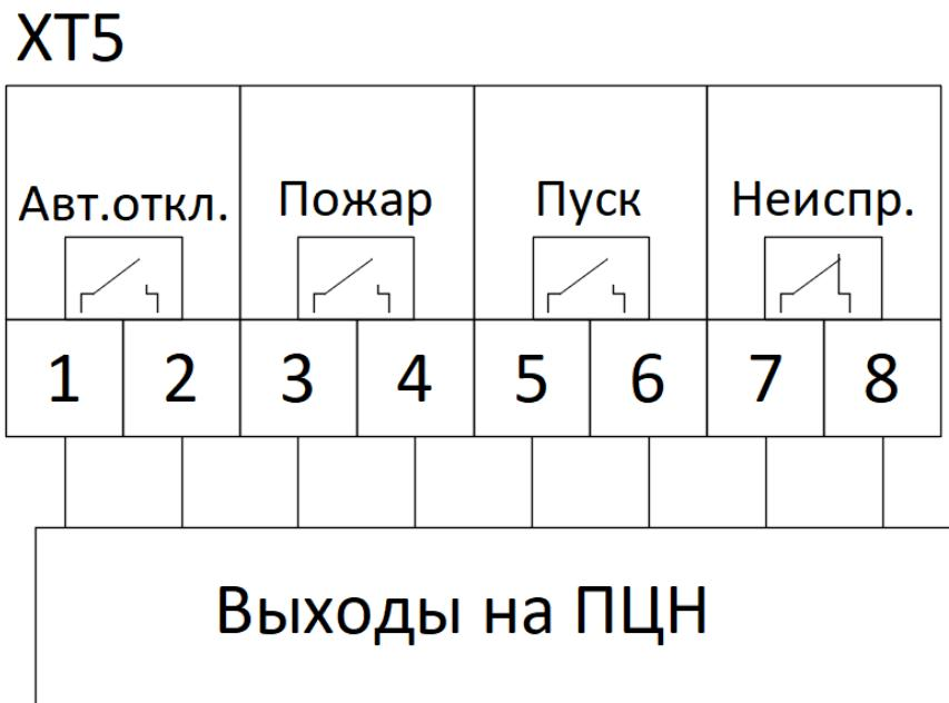
Рисунок 12 – Контакты для подключения выходов на ПЦН.
