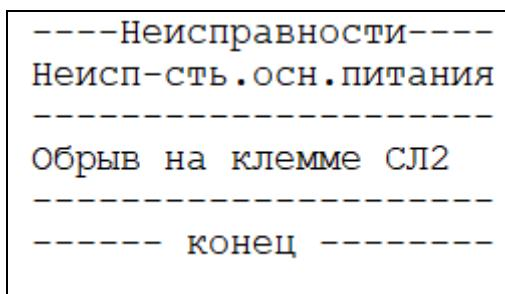
Рисунок 46 – Пример меню КЛ-240АЭ «Неисправности».
