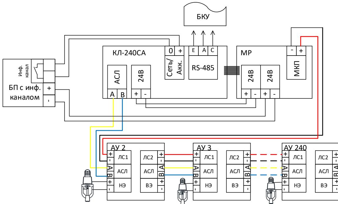
Рисунок 56 – Схема подключения ИПТ-СкА / СА / А.
