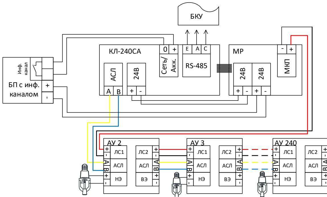
Рисунок 60 – Схема подключения МКП-СкА / СА.
